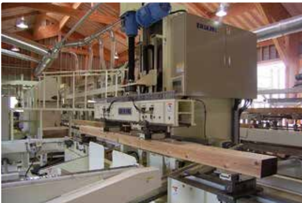
JAS(日本農林規格)で認められている測定機器を使用し、乾燥具合(含水率)や強度性能(ヤング係数)の測定を行っています。
