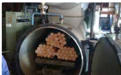
防虫防蟻剤を注入 塗布よりも効果大
