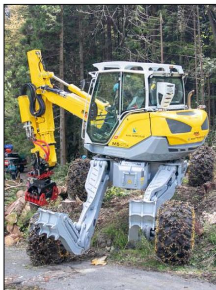
スイスのメンツィムック社製の4輪多関節型作業機械。
