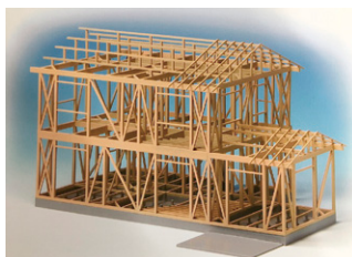
二級建築士試験教材模型 筋交いと火打、金物などの斜め材が多用されている最近の住宅の骨組み。
