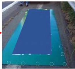
標識板補修用の重ね貼りシートの落下事例
