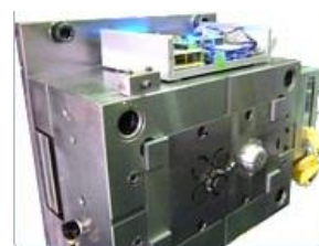
産学官連携で開発したスマート金型 (素材温度等を測定するセンサーを設置)
