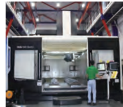
マシニングセンタ (DMG森精機製 門型5軸MC [DMU 340 Gantry])
