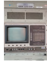
振動試験機 製品を加振して振動解析や耐久性を調べる装置
