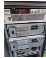
電源・電子負荷装置 製品の試運転や電力負荷を疑似的に再現して性能試験や故障解析を行います
