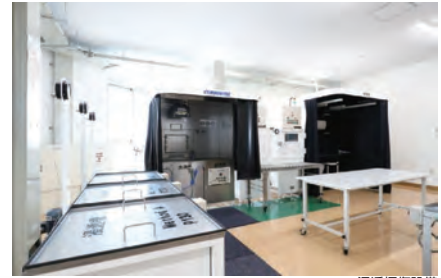
浸透探傷設備
