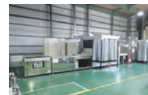
浸透探傷検査設備 (ASTME1417他各社規格対応可)
