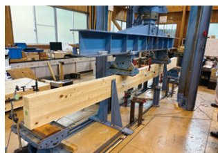
写真3 ヒノキ接着重ね材強度試験状況
