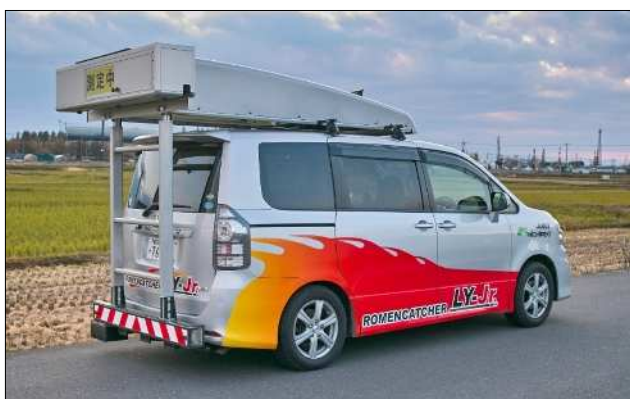
写真 3-1 路面性状自動測定装置の例
