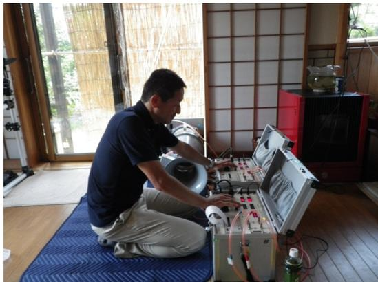
測定結果は、C 値（相当隙間面積：延床面積に対する隙間量）という値で表されます。
