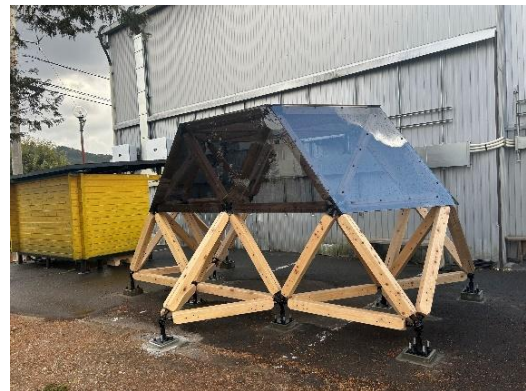
木材立体トラス構造 試験体制作
