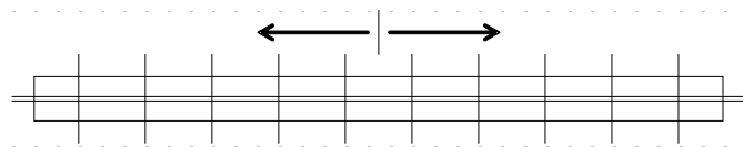
図1-1 ボルト締付け順序
