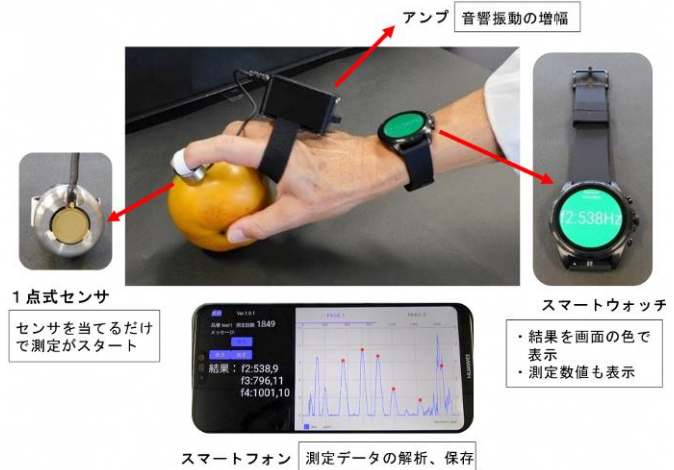
図2 開発した1点式センサの携帯型装置
