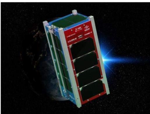
超小型人工衛星はキューブサットと呼ばれ、1ユニット（1U）が10×10×10cmの大きさです。1～3Uの大きさで1～4kgの極めて小さな人工衛星は、教育用から宇宙探査、ビジネスまで幅広く活用されている。
