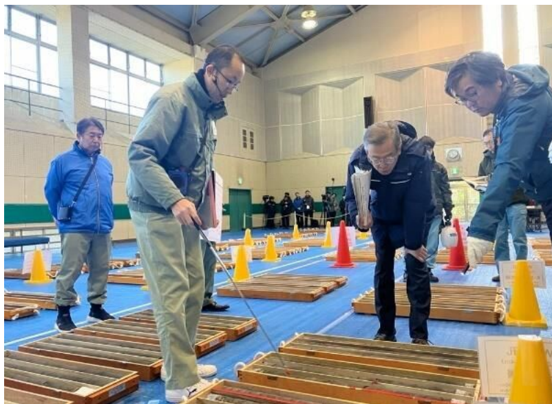
H断層系の分布及び活動性評価に係るボーリングコアを確認している様子
