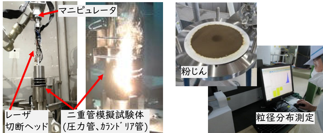
原子炉水中解体モックアップ試験
