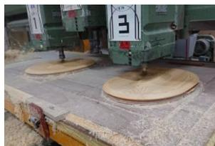
▲座面の複雑なカーブはマシン切削機で粗削りします。
