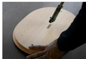
▲シート裏面に焼き印を施し、組み立て工程に移ります。
