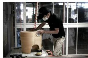
▲木釘をしっかり打ち込み研磨した後、塗装工程を経て完成です。
