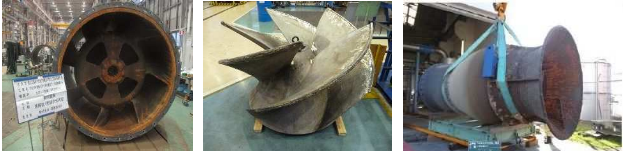
図 3-17 ポンプ設備の老朽化状況
