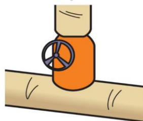
蒸気バルブの保温イメージ
