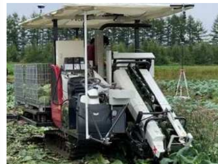
開発中のキャベツの自動収穫機
