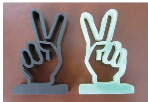
Left : CFRP (t15.0) Right : GFRP (t15.0)
