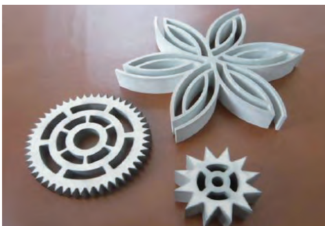
bottom Left : titan (t10.0) top Right : A5052 (t20.0) bottom Right : SUS304 (t25.0)
