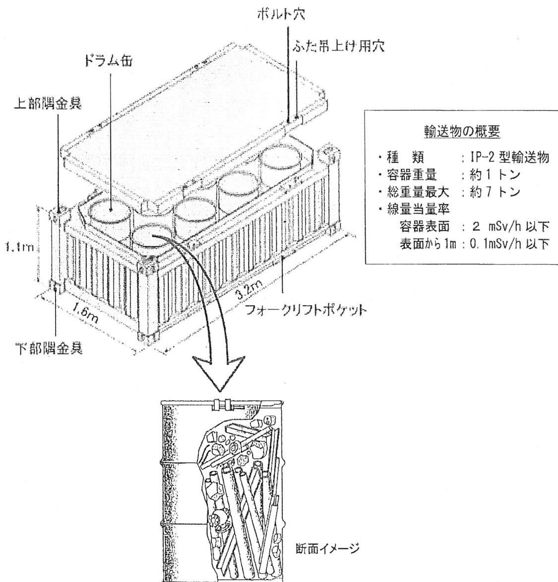
輸送する低レベル放射性廃棄物は、発電所で発生した金属やプラスチック、フィルタ類などの固体状の廃棄物を種類毎に分別し、ドラム缶に収納した後、セメント系充てん材（モルタル）で固めたものです。
