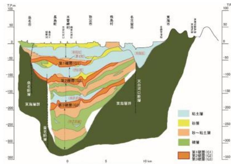
濃尾平野の地層断面(A-A' 測線: 桑原(1985)を一部改変)
