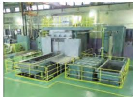
熱処理溶体化炉
