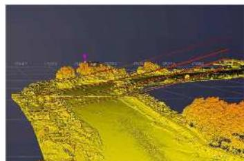
点群データによる高压線の図化
