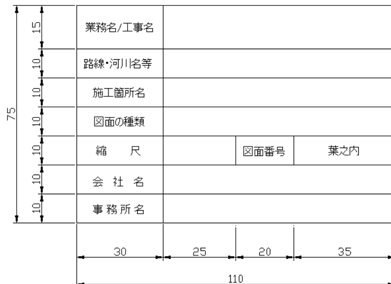
図 7-1 表題欄の様式および寸法 (mm)
