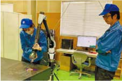
非接触式三次元測定機は、男女問わず未経験の方でも高精度な測定が可能。一人でできるようになるまで上長が付き添い研修を行う。
