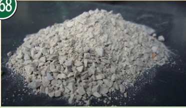
リサイクルサンド5-0 陶磁器くず(廃タイル) (有)熊谷産業 TEL 0572-57-3455
