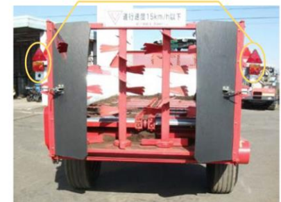
後部反射器及び灯火器類の設置例
