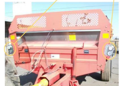
後部反射器及び灯火器類の設置例
