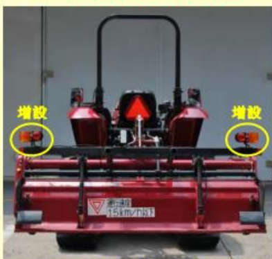
<直装式作業機で本体の灯火器類が見えない例>
