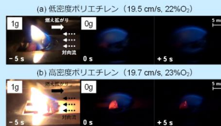
通常/微小重力環境における(a)低密度ポリエチレンおよび(b)高密度ポリエチレン上の火災の燃え広がり挙動
