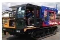
取水ポンプ車 (クローラ型・車両型)
