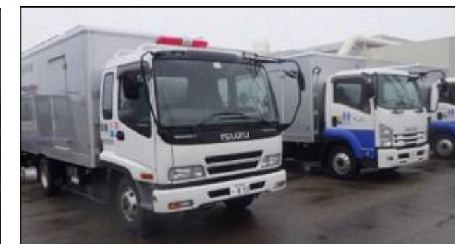
③高圧電源車
