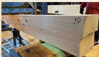
図2 内部割れ(上)とせん断破壊した平角材(下)
