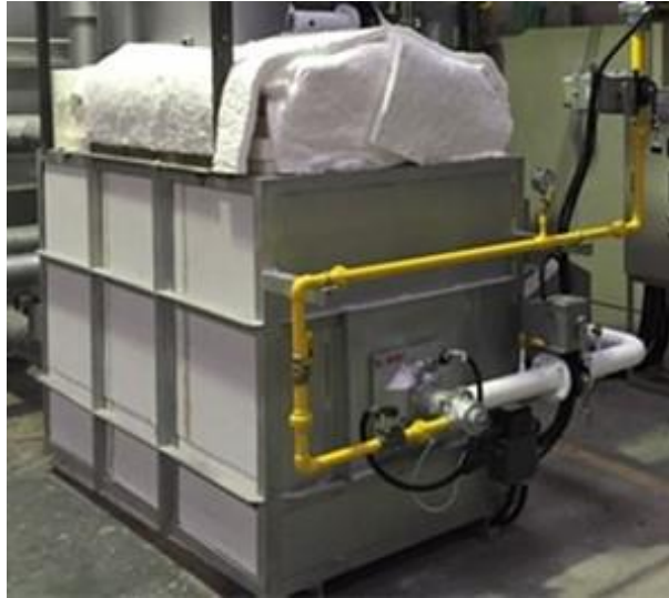
小型ガス炉(炉内容積約0.7m 3 )
