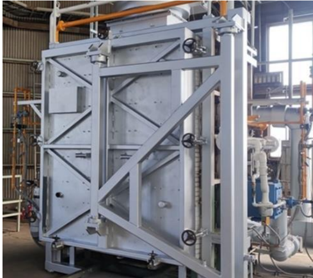
検証炉(炉内容積約2m 3 )
