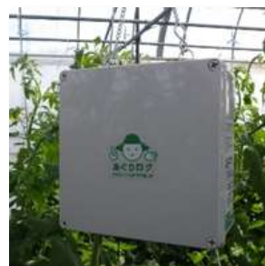
環境モニタリング装置 ハウス内の温度・湿度等を自動測定
