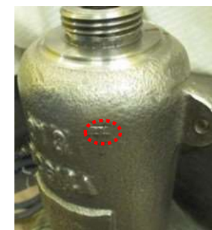
打痕を確認 (長さ9mm、幅1mm)
