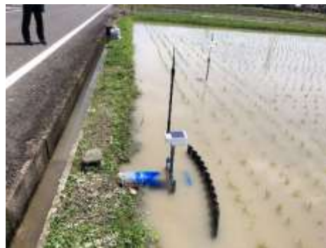
自動給水ゲート(水田ファーム) (農業技術センターにて展示)
