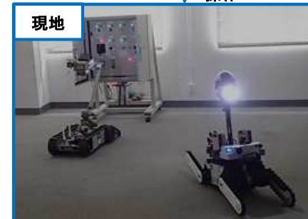
建屋内、暗所を想定したロボットによる操作盤操作
