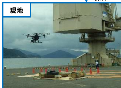
無線ヘリによる上空からの偵察、放射線量の測定
