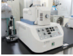
E B S D解析用断面試料作成装置 イオンミリング装置 E-3500 (株)日立ハイテクノロジーズ
