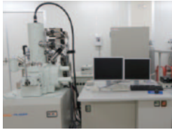
集束イオンビーム 高分解能走査電子顕微鏡複合装置 JIB-4600F 日本電子(株)
