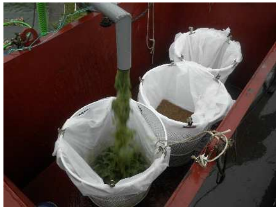
写真 3. 5 フィルター材によるアオコの回収(H28、H30、R1 実施)
