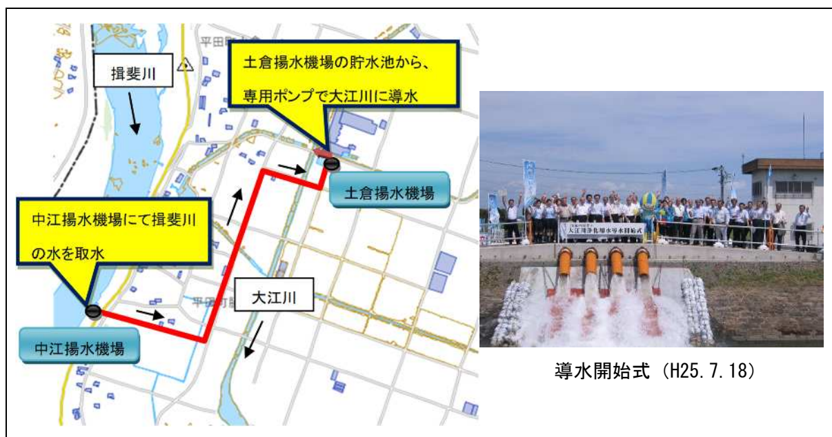
図 2.5 導水実施状況
