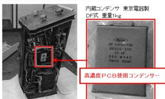
高圧発生器に、高濃度PCBを使用したコンデンサーが内蔵されていた場合
