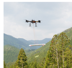
<ドローンによる資材運搬（郡上市）>
