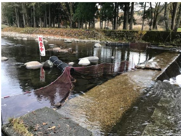
遡上状況調査 魚道の上流に遡上した魚を採捕 (採捕した魚は再放流)
