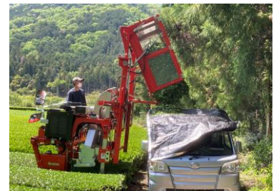
【コンテナ式乗用摘採機の移し替え】
