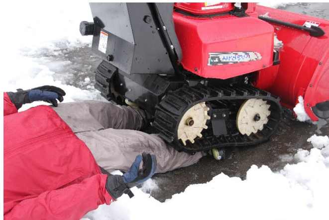
○除雪機の下敷きになる事故の再現
