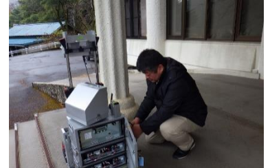
(写真 3-2) 可搬型ポスト設置
