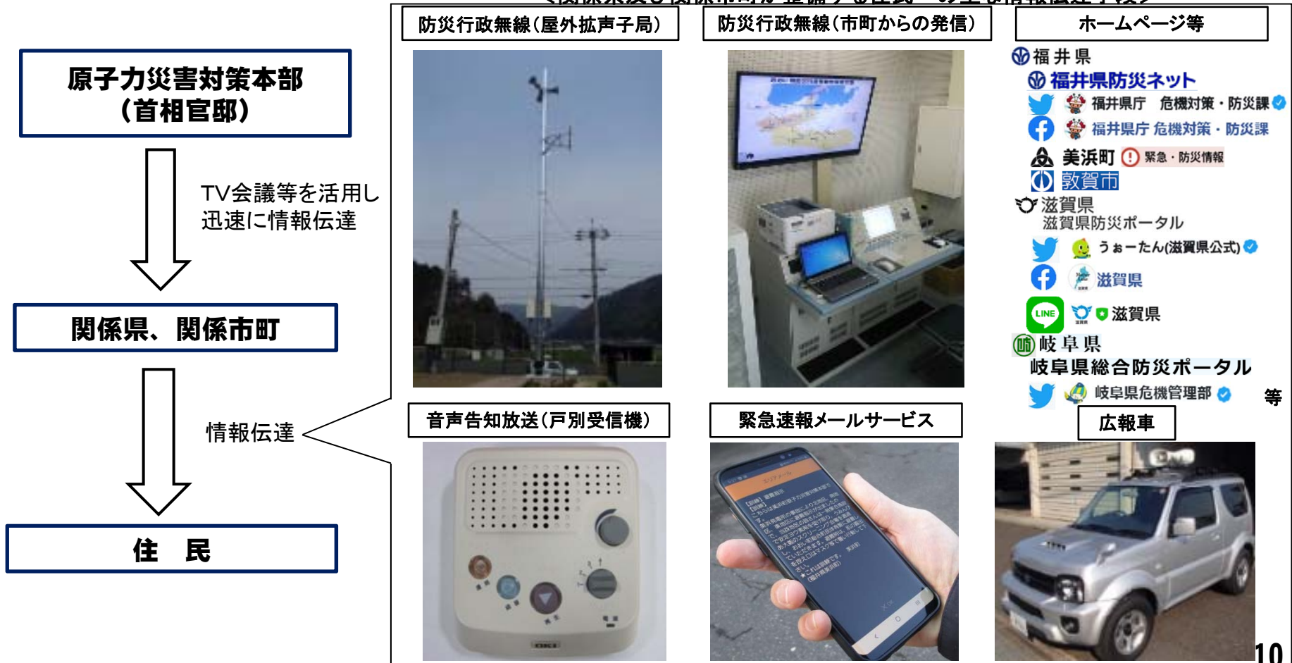
＜関係県及び関係市町が整備する住民への主な情報伝達手段＞
