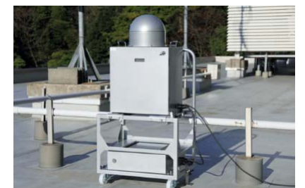
可搬型モニタリングポスト(例) [バッテリー付]
