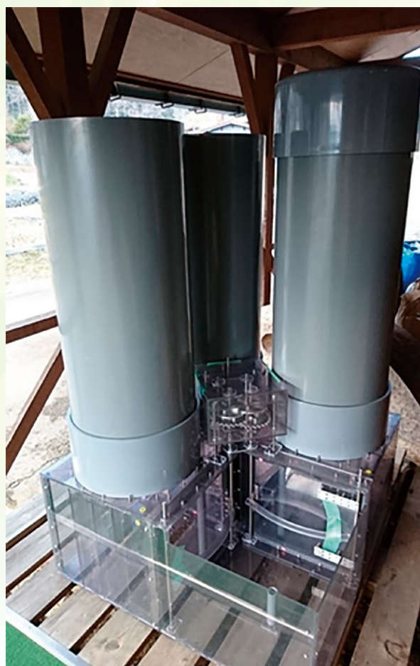
タンク式小水力発電施設
