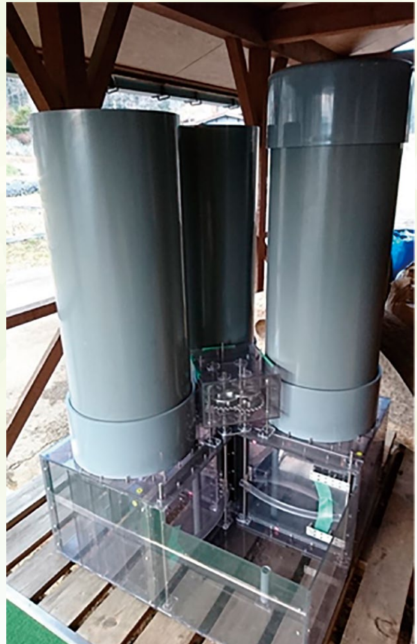
タンク式小水力発電施設
