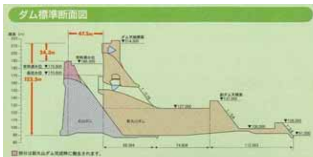
図- 11 新丸山ダム標準断面図
